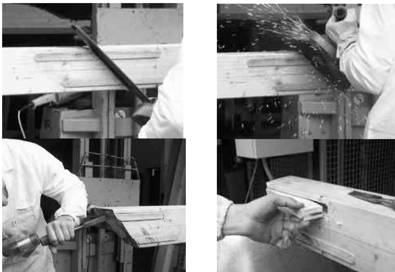
Figure 1-4. Le varie di lavorazione per la imozione della protesi sui travetti realizzati in laboratorio
