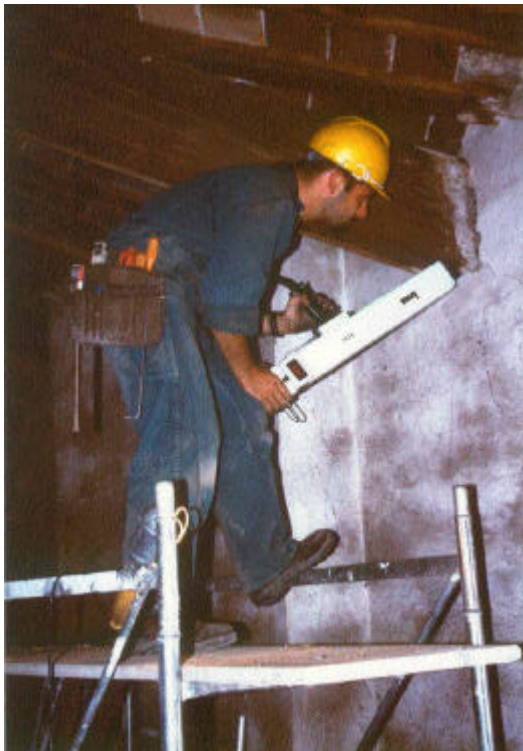
Indagine strumentale (resistografica) all'appoggio di una trave di copertura
